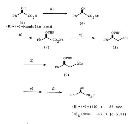
a) EtOH/H<sup>+</sup> b) dihydropyran/CH<sub>2</sub>Cl<sub>2</sub> c) LiAlH<sub>4</sub>/Et<sub>2</sub>O d) TsCl/ pyridine e) CsF/triethyleneglycol f) H<sup>+</sup>
